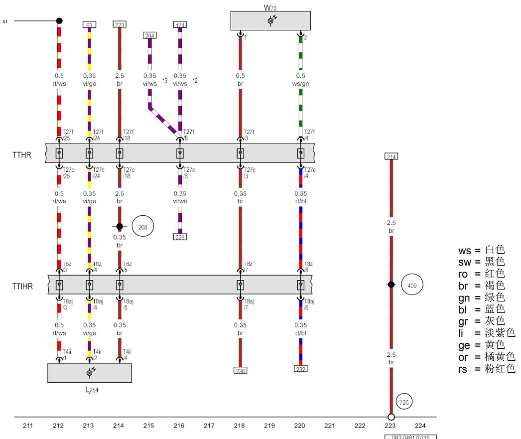
右后车门控制单元，右后烟灰缸照明灯泡，右后车门操纵台照明灯，副驾驶员侧后部车门内把手照明，右后车门轮廓照明灯，右后车门警告灯
