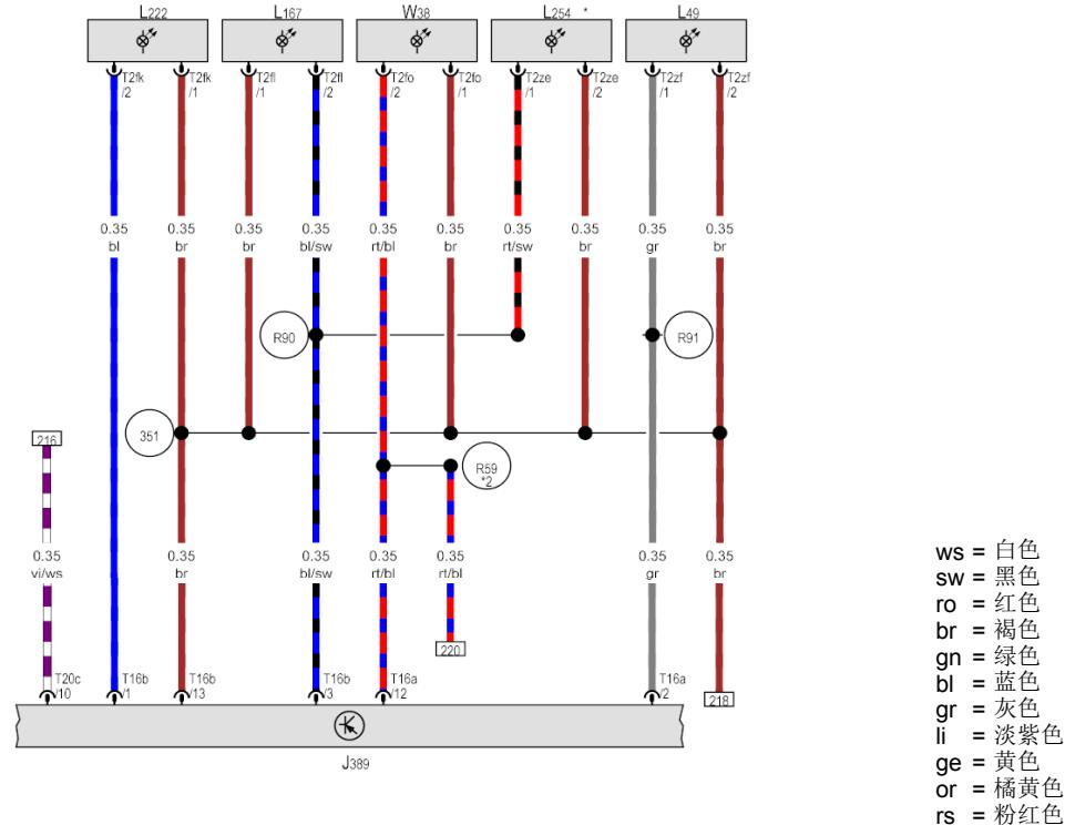
副驾驶员侧带照明功能的化妆镜，驾驶员侧带照明功能的化妆镜，左后脚部空间照明灯，右后脚部空间照明灯
