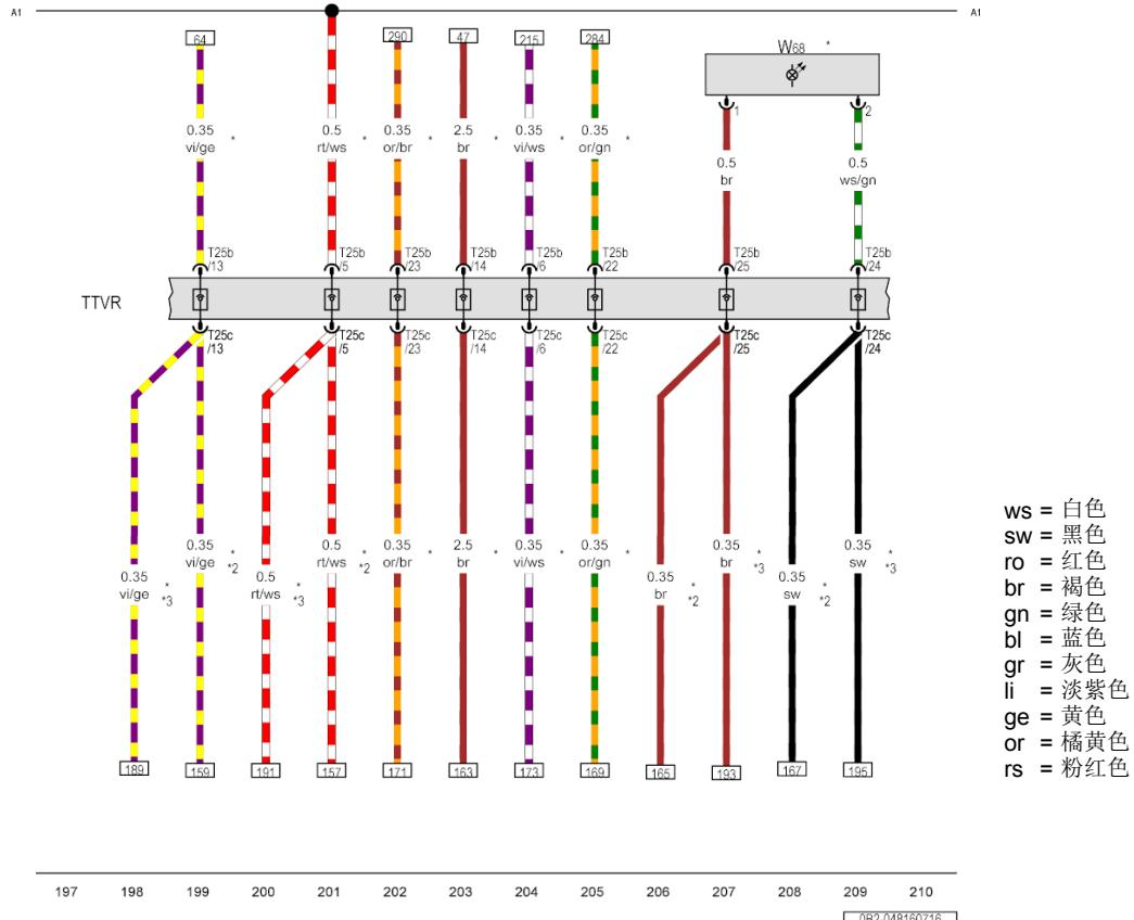
右后车门轮廓照明灯，右后登车护条背景照明的光导管
