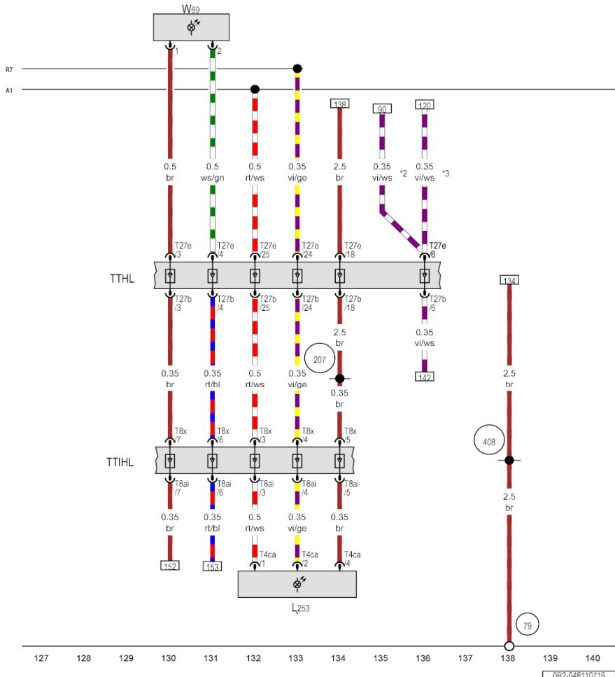
左后车门轮廓照明灯，左后登车护条背景照明的光导管
