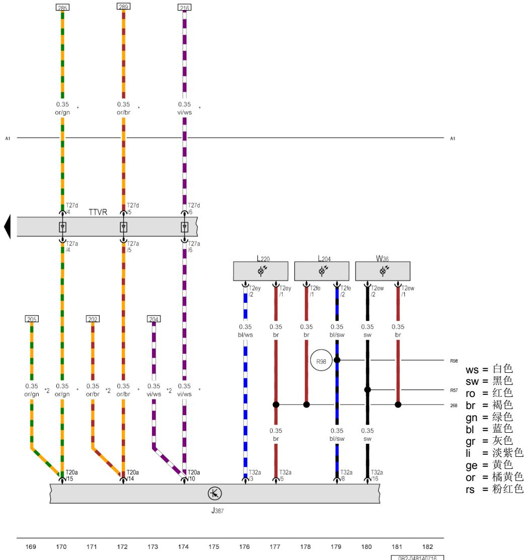
副驾驶员侧车门控制单元, 右前车门背景照明灯 2, 副驾驶员侧车门内把手照明, 副驾驶员侧车门警告灯
